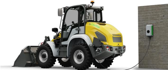
**Batterietechnologie:** Leistungsfähige 96 V Lithium-Ionen-Batterie mit einer Kapazität von 37,5 kWh
