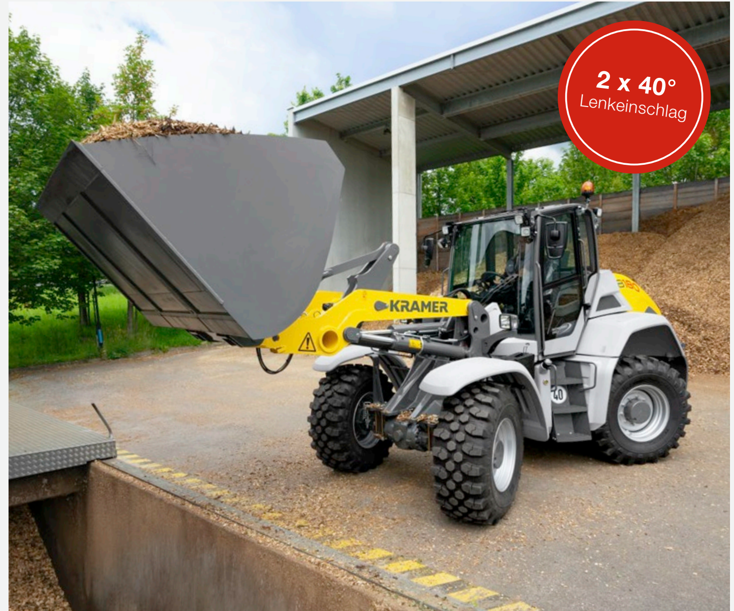
Allradlenkung besonders wendig bei eingeschränktem Platz
